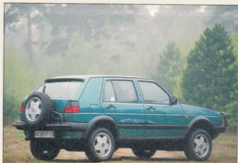
Zwischen Karosserie und Fahrwerk sitzt ein stabiler Längsrahmen. Dadurch kommt die Karosserie um 120 mm höher, das Fahrwerk ist 60 mm höher gelegt
